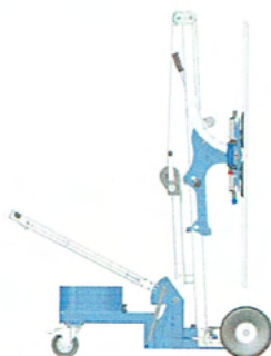
Mastpositie parallel aan vooras (Opnemen/Afzetten van last)
