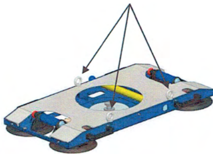
Vakuum-Hebeanlage, horizontal, drei Anschlagpunkte über drei Ringschrauben
