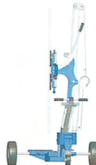
Mastpositie dwars op vooras (transporteren van last)
